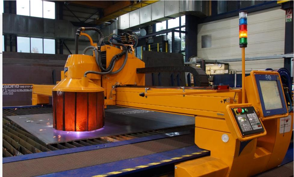
Uso de máquinas de corte laser, oxígeno y plasma para cortar planchas sometidas a presión
