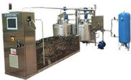
CABINAS DE DOSIFICACIÓN AUTOMÁTICAS, PESADA Y DISOLUCIÓN DE PRODUCTOS
