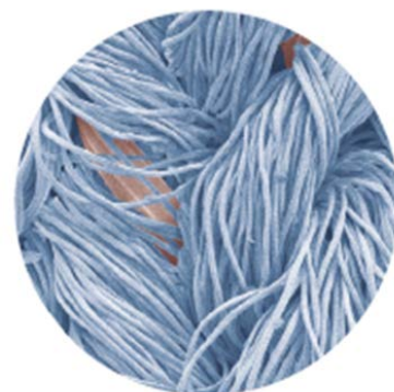
Fig. 3. Las fibras textiles (azules) pueden obtener un acabado impermeable uniforme mediante un recubrimiento de plasma. Incluso las fibras elásticas más exigentes (rojas) permanecen impregnadas permanentemente gracias al nuevo proceso (microscopía electrónica de barrido, coloreada). (Fuente: EMPA)
