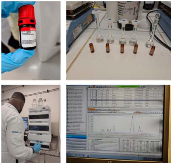
Imagen 5: Desarrollo del análisis de Permetrina en materiales textiles.
